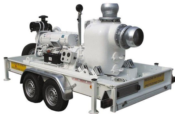
Traileriasennettu hätäpumppu J 300
